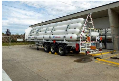
**Trailer:** Air Liquide (200bar mit ca. 300kg H<sub>2</sub>)
