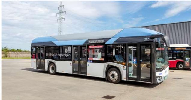
**Fahrzeughersteller:** Solaris mit Ballard-Brennstoffzelle (350bar)
